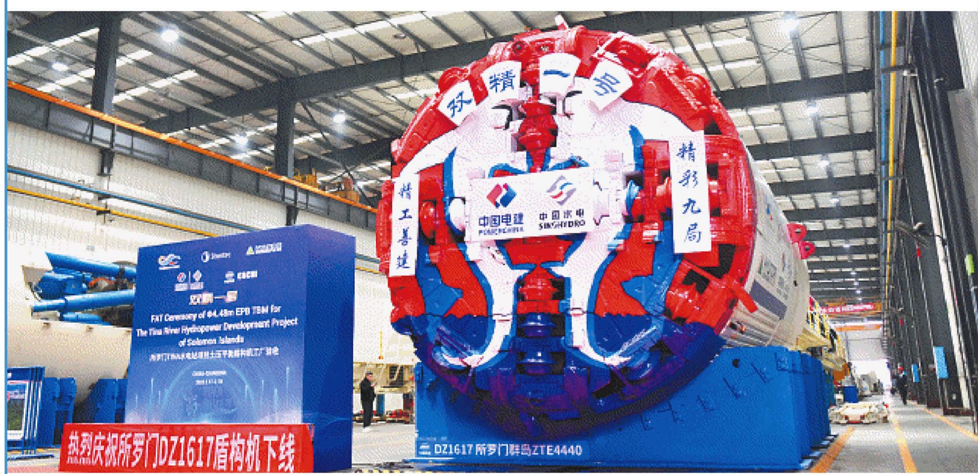
开挖直径为4.48米的盾构机“双精一号”在铁建重工长沙第二产业园下线。长沙晚报通讯员 胡清 供图
